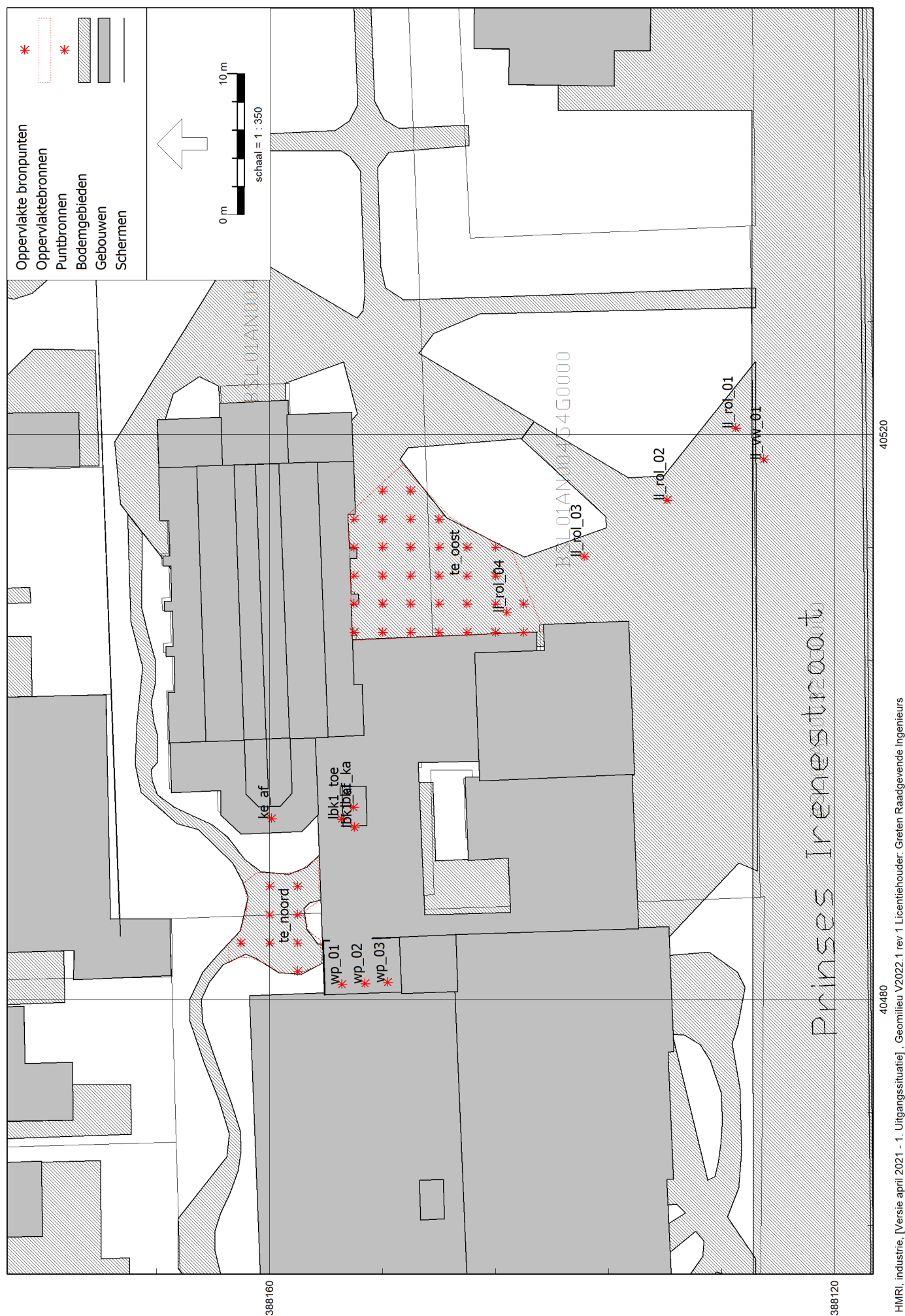
Figuur 3 - Equivalente geluidbronnen dorpshuis gedeelte terras, installaties en laden en lossen
