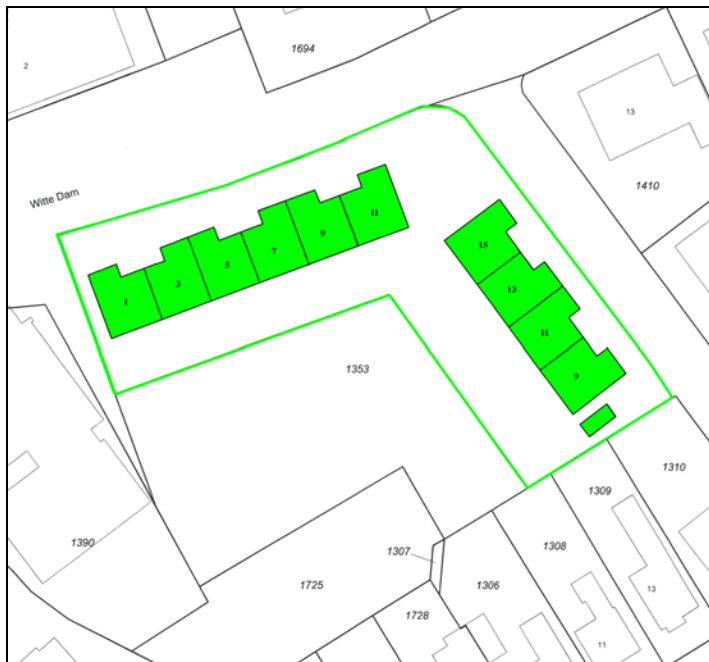
Afbeelding 6. De zone waarbinnen de sloopwerkzaamheden zullen worden uitgevoerd (lichtgroen omkaderd) en de te slopen bebouwing (lichtgroen gemarkeerd), geprojecteerd op een uitsnede van de kadastrale kaart Gemeente Borsele, Sectie AK, nr. 1353. Schaal 1: 1.000.
