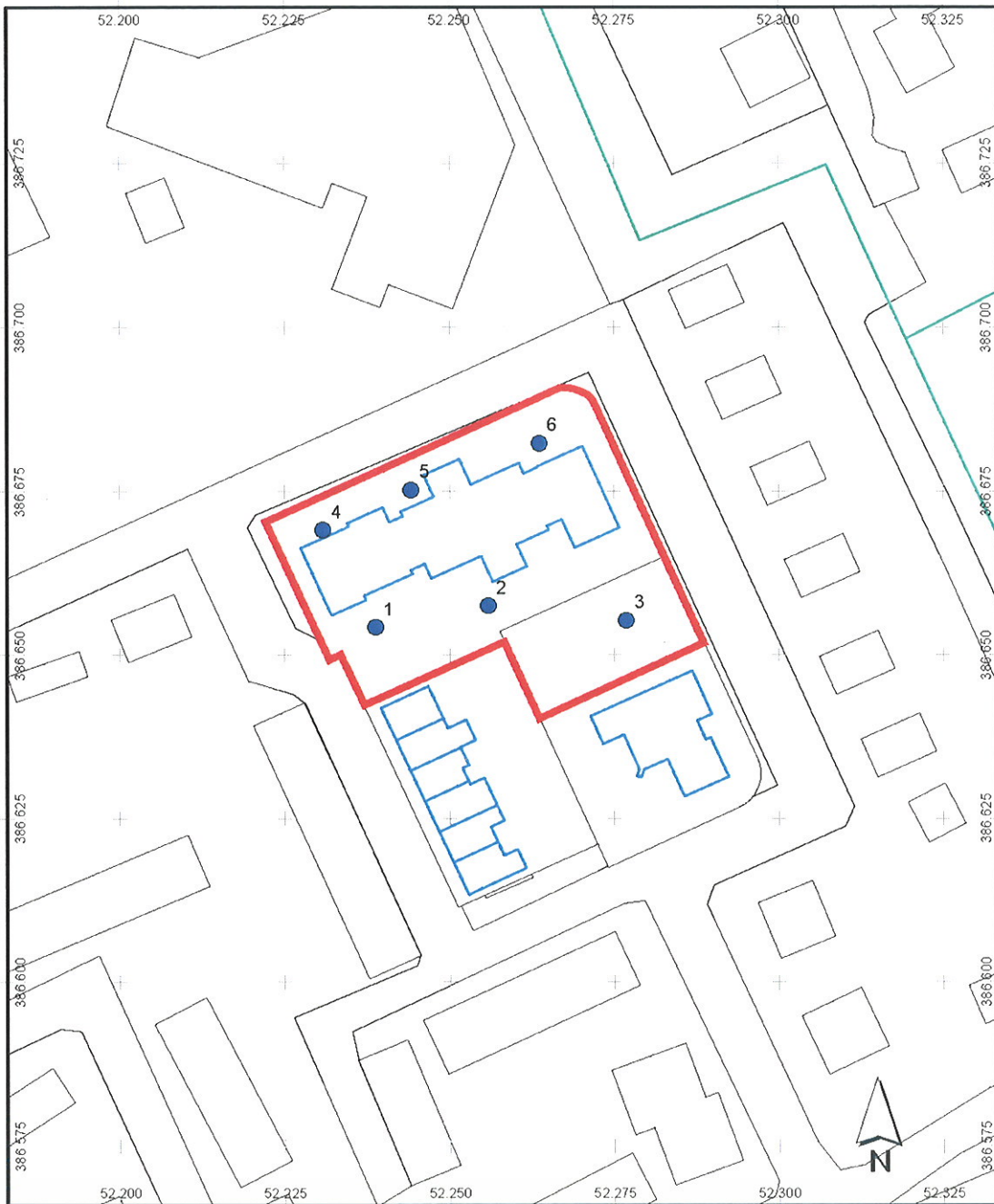
Afbeelding 4. De positie van de boorpunten van het IVO (in blauw), geprojecteerd op een uitsnede van de Kadastrale Kaart. Het onderzoeksgebied is rood omkaderd. Schaal 1: 1.000. ©Topografische Dienst Kadaster, Emmen [2008].
