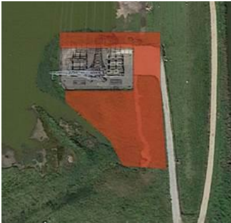
Figuur 2.6 Oppervlak tijdelijk te ontgraven t.b.v. aansluiting OSP (500m 2 )
