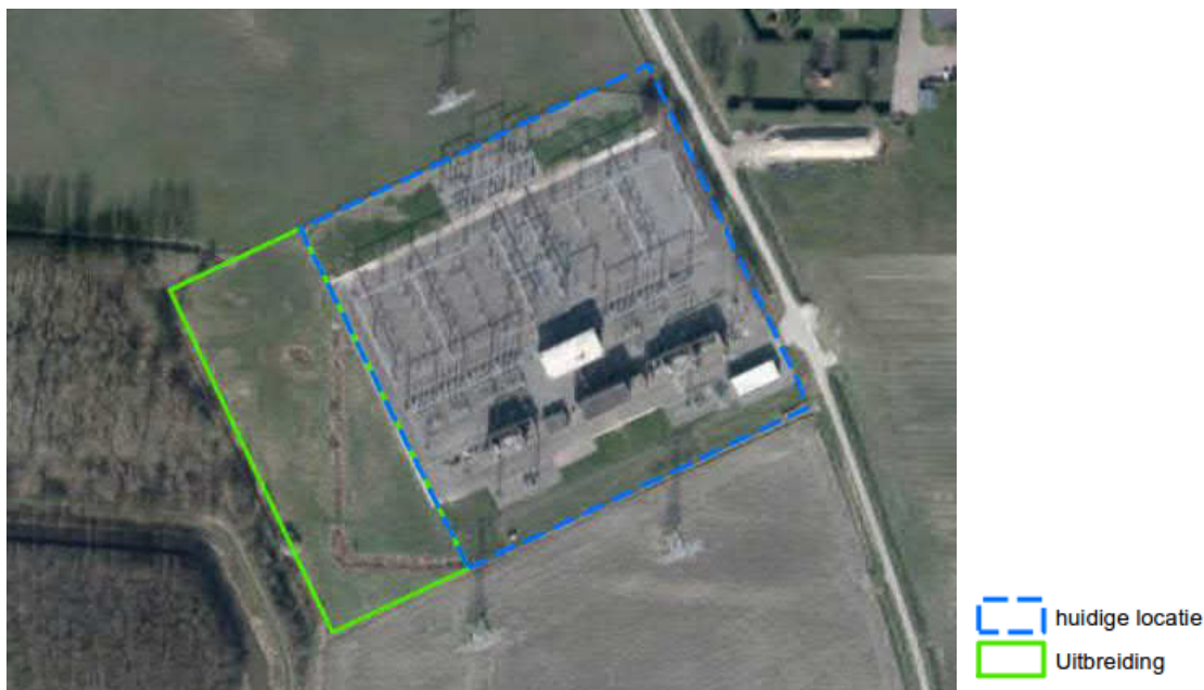
Figuur 3.3 Uitbreiding 150 kV-station Goes de Poel
