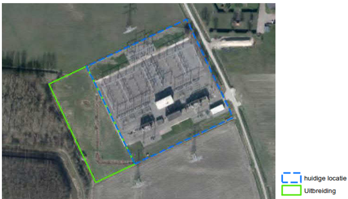
Figuur 2.5 Uitbreiding 150 kV-station Goes de Poel
