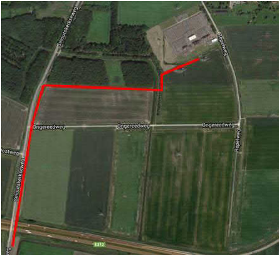
Figuur 4.1 Ligging variant kabelverbinding naar het 150 kV-station
