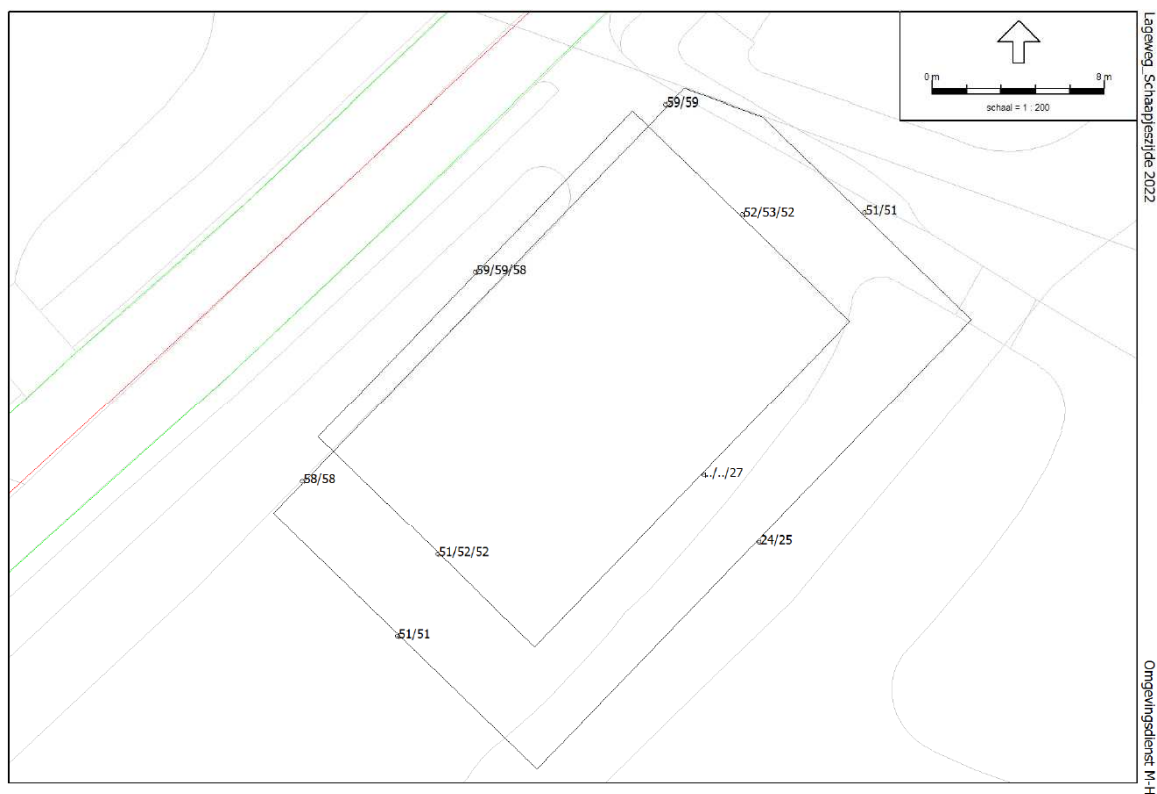
Figuur 8: Berekeningsresultaten geluidsbelasting Lageweg 38a, ontvangerhoogte 1,5/4,5/7,5 m
