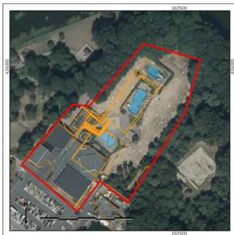
Figuur 16: Locatie van kabels en leidingen volgens de KLIC en bouwtekeningen (bron: KLIC en bouwtekeningen van de gemeente Zijndrecht).
