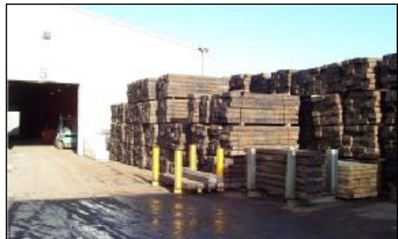
Figuur 4: Opslag van spoorbielzen voor hergebruik
