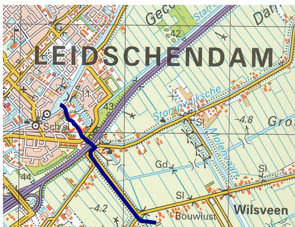
Figuur 8: aanvoertracé leiding vanaf sluis Leidschendam
