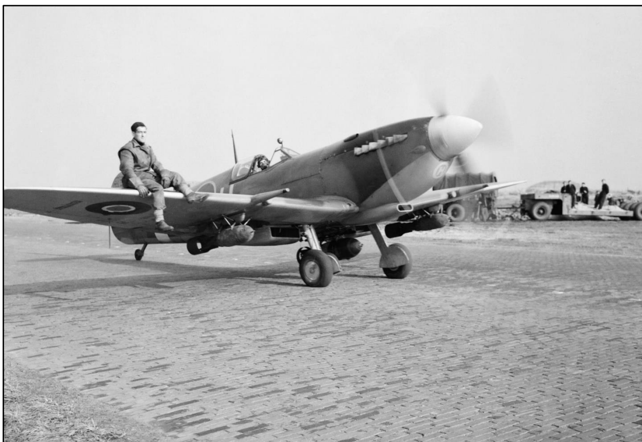
Figuur 24. Een Spitfire Mk IX van het Canadese 412 Squadron met onder beide vleugels een 250 lb.-bom en een 500 lb.-bom onder de romp. (Bron: commons.wikimedia.org)
