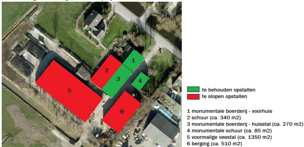
Afbeelding 2: huidige situatie projectlocatie
