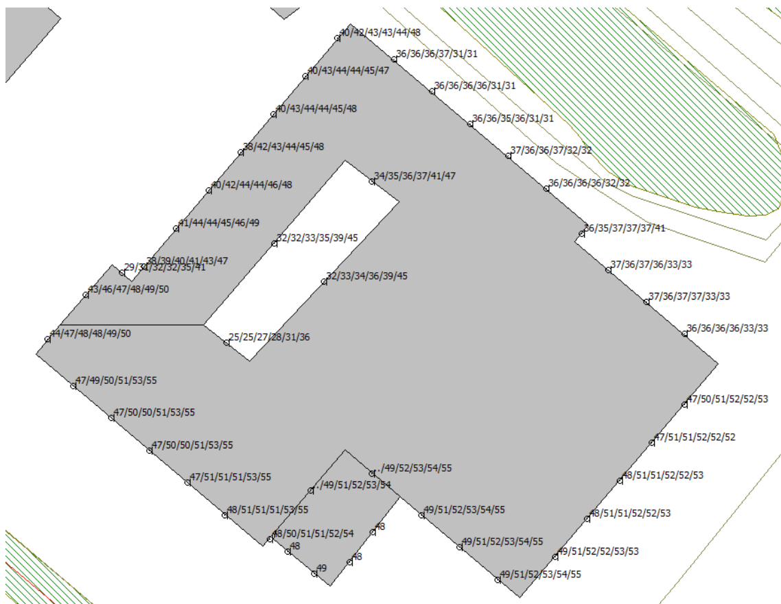
Figuur 4.1 Geluidsbelasting ten gevolge van de A12 op de gevel
