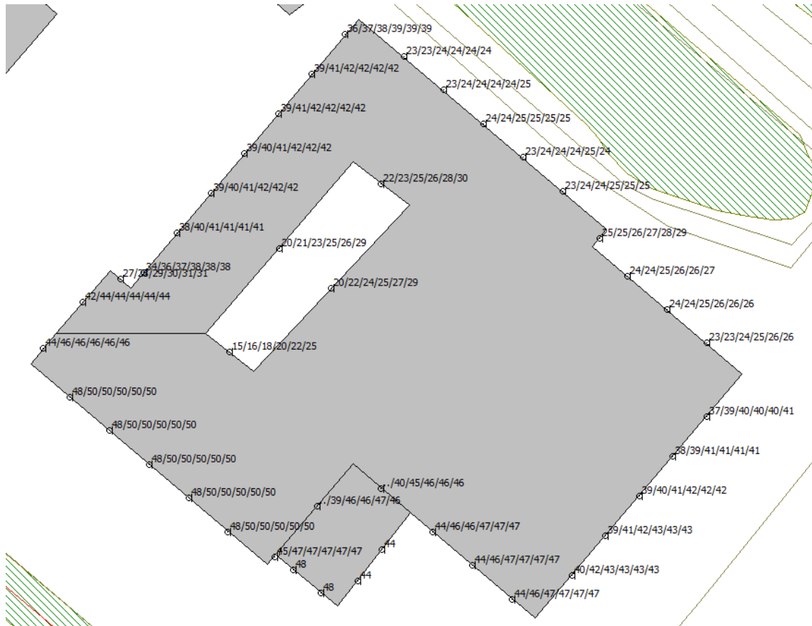
Figuur 4.4 Geluidsbelasting ten gevolge van de Werner von Siemensstraat op de gevel
