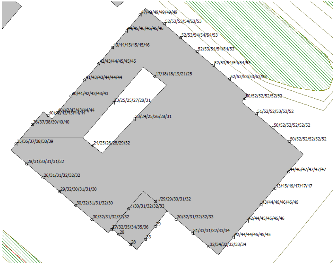
Figuur 4.3 Geluidsbelasting ten gevolge van de Bleiswijkseweg op de gevel
