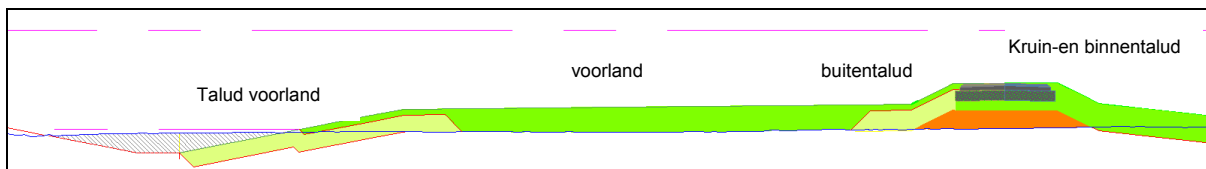
Figuur 4.3 Principeprofiel kleibekleding kaden Middengebiet
