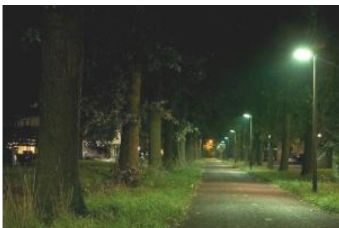
Figuur 6.4 Vleermuisvriendelijke verlichting. Geschikte verlichting vanwege zo kort mogelijke, of gebogen lantaarnpalen, lichtbeperkende armaturen zonder uitstraling naar boven toe en “zacht groen”.
