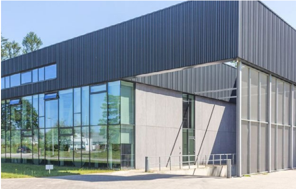
Opstelplaats expeditie binnen hoofdvolume. Halfverdiepte bak vereenvoudigt laden/lossen in bedrijfsgebouw. NB. verticale geleding is in dit voorbeeld onvoldoende zichtbaar
