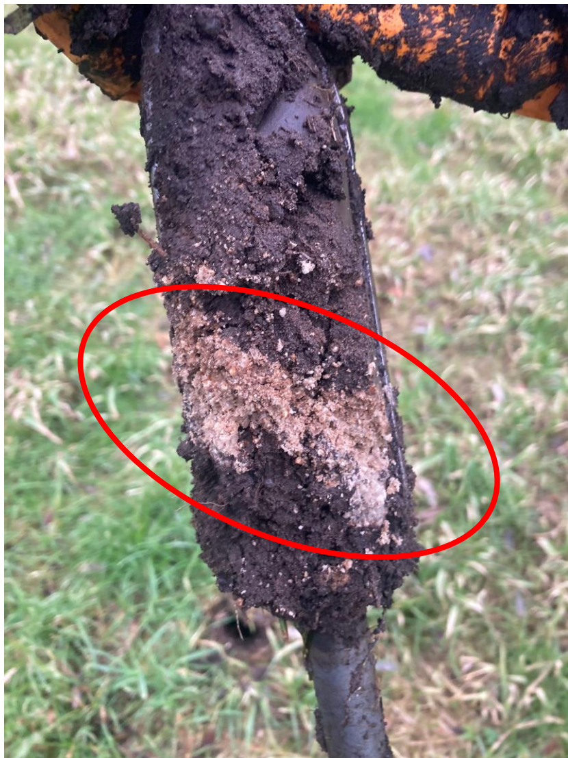
Figuur 1: Foto restant stabilisatielaag puimsteenkorrels / BIMS
