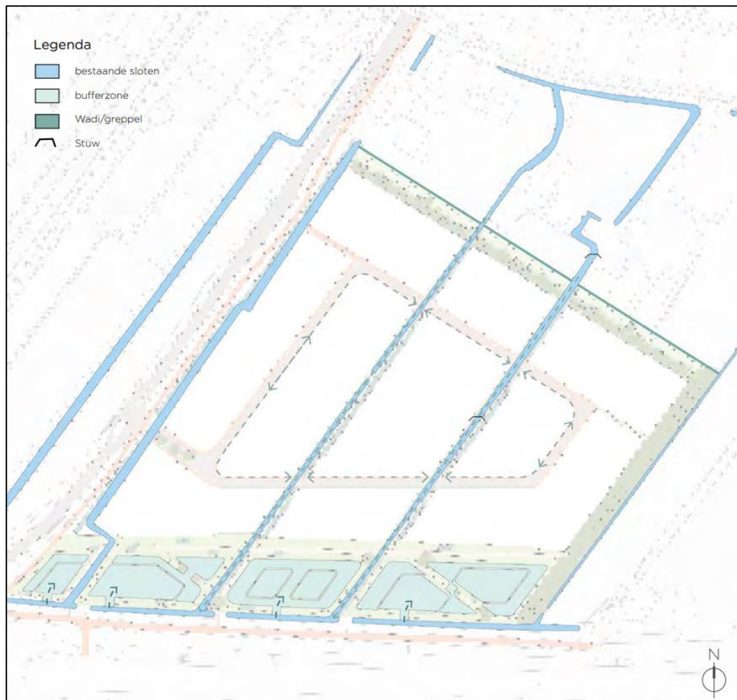
Figuur 4-2 Toekomstig oppervlaktewatersysteem (bron: Waterhuishoudkundig plan – Bedrijventerrein Burgemeester van Zwietenweg, 11-11-2022, Sweco)
