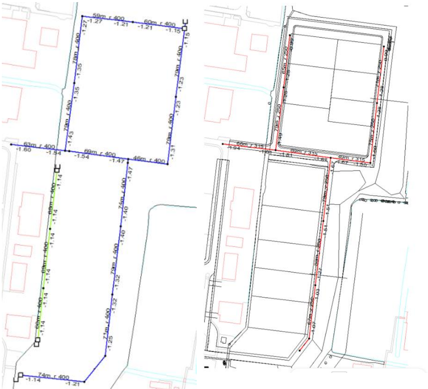
Figuur 4-3 Toekomstig rioleringsstelsel. Links HWA (blauw) en DIT (groen). Rechts vuilwaterstelsel. (bron: Waterhuishoudkundig plan Bedrijventerrein Putkop, versie D.2, 09-01-2023).
