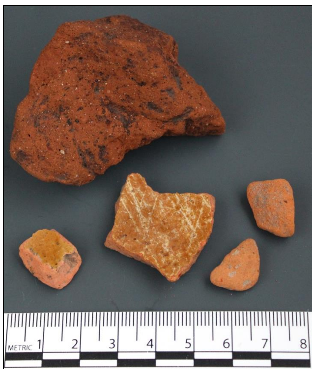
Figuur 11: Fragmenten roodbakkerend geglaazuurd aardewerk uit boring 6 (rechter fragment) en boring 2 (linker fragment) en een groot fragment baksteen en twee kleinere uit boring 6, afgebeeld op ongeveer ware grootte.
