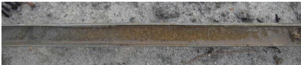
Figuur 15: Foto van het onderin alle boringen aangetroffen zand dat tijdens het veldonderzoek dermate waterverzadigd was dat het rond de diepte van 2,5 meter beneden maaiveld uit de guts stroomde.
