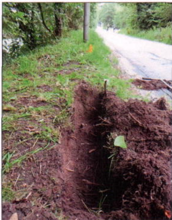
Intensieve beworteling bij een potentieel te behouden volwassen esdoorn. De berm ligt hier ten opzichte van de rijbaan circa 20 cm hoger.
