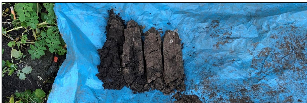
Boring 2: 0-50 cm -Mv. Meermaals gestaakt op een pakket puin, een betonband en een leiding.
