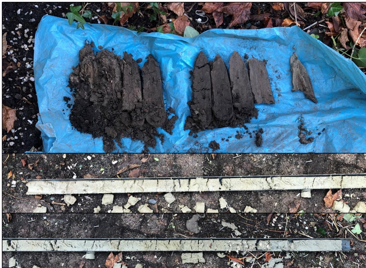
Boring 1: 0-270 cm -Mv. De bovenste rij boorkernen betreft het traject boorkernen tot een diepte van circa 110 cm -Mv, de middelste en onderste foto zijn uitgevoerd met een zuigerboor. op een diepte van circa 240-250 cm -Mv is een pakket zeer schelprijke afzettingen aangetroffen.
