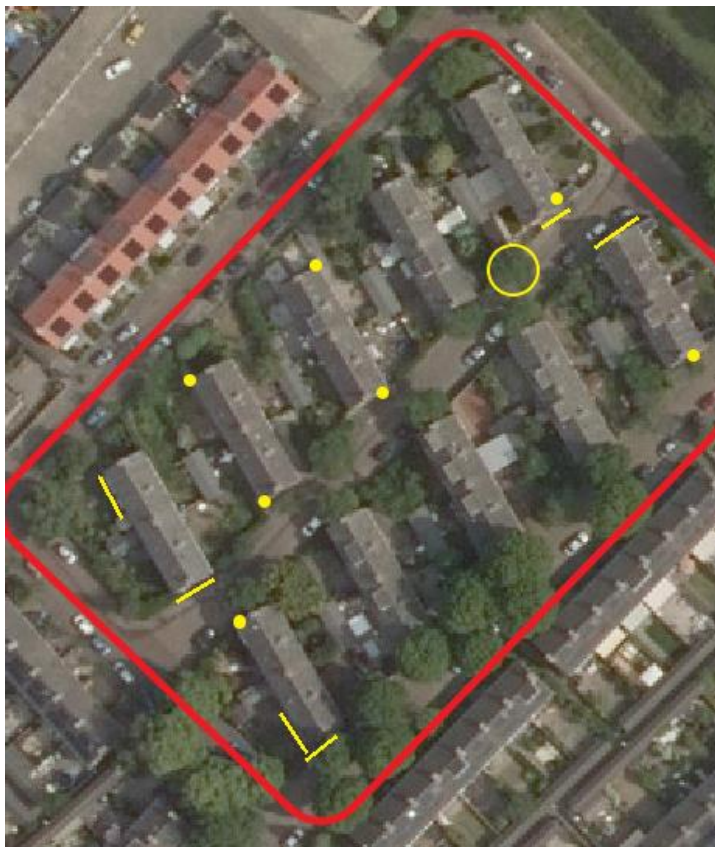
Figuur 2: potentiële verblijfplaatsen vleermuizen (gele lijn: open stootvoegen, gele stip: openingen op de hoek, gele cirkel: boom met holte)
