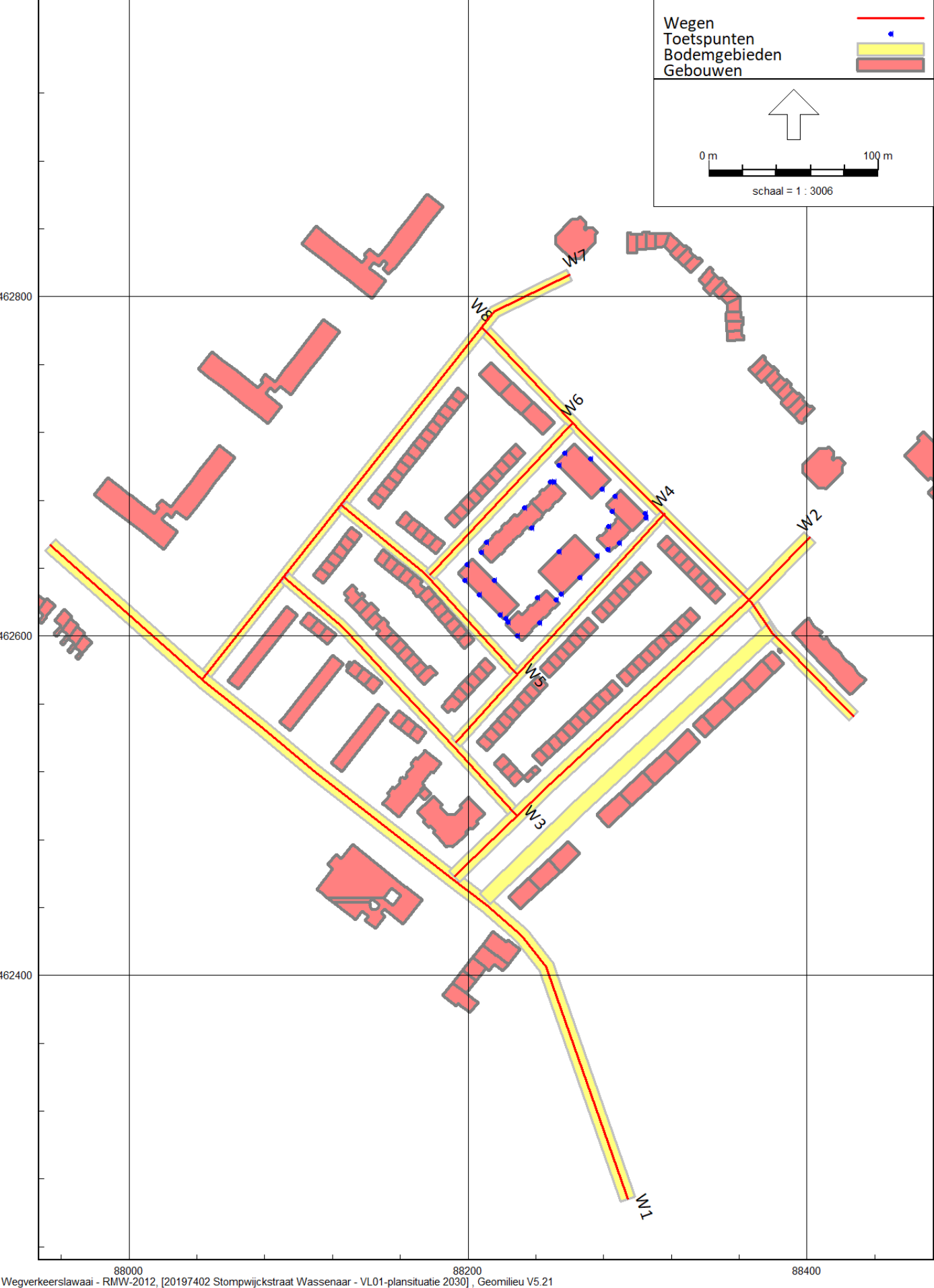
Figuur 1 | Overzicht rekenmodel met identificatie van wegen
