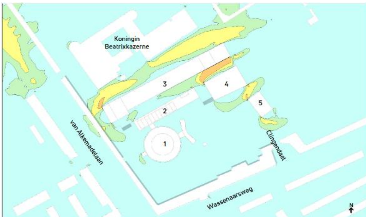
Figuur 4.2 Windhinder op voetgangersniveau voor de bestaande situatie (boven) en de toekomstige situatie (onder)
