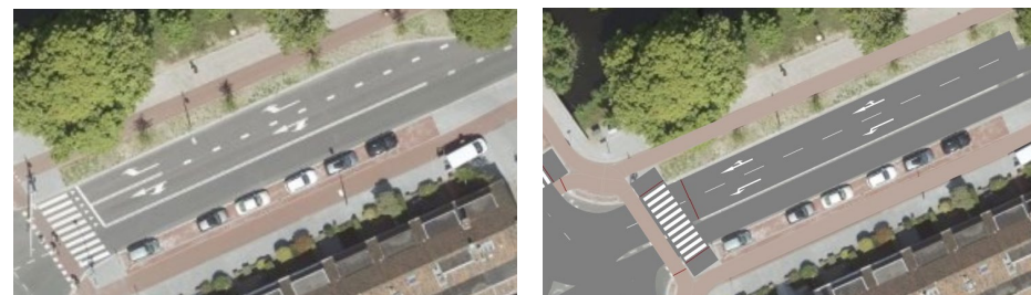
Figuur 4 Links: bestaande situatie Wassenarseweg. Rechts: voorstel nieuwe indeling opstelstroken Wassenarseweg.
