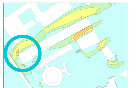
Figuur 4.5: Stroomlijnen nabij de noordwestkant van de nieuwbouw bij de bepalende windrichtingen.
