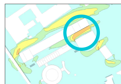
Figuur 4.6: Stroomlijnen tussen gebouwen 2, 3 en 4 bij de bepalende windrichtingen.
