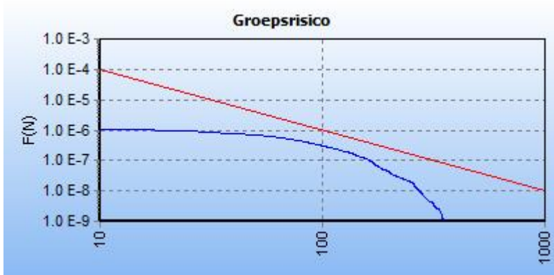
5.2 Figuur 5.2 FN curve voor 7945_leiding-W-514-18-deel-1 van N.V. Nederlandse Gasunie voor de kilometer tussen stationing 0.00 en stationing 0.00
