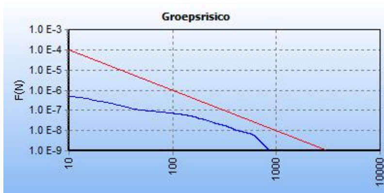
Afbeelding 5 fN-curve buisleiding W-514-deel-1, huidige situatie
