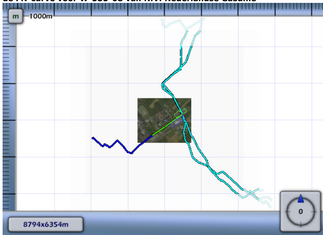
Figuur 4.6 Kilometer leiding behorende bij de maximale overschrijding van de FN-curve voor W-535-08 van N.V. Nederlandse Gasunie
