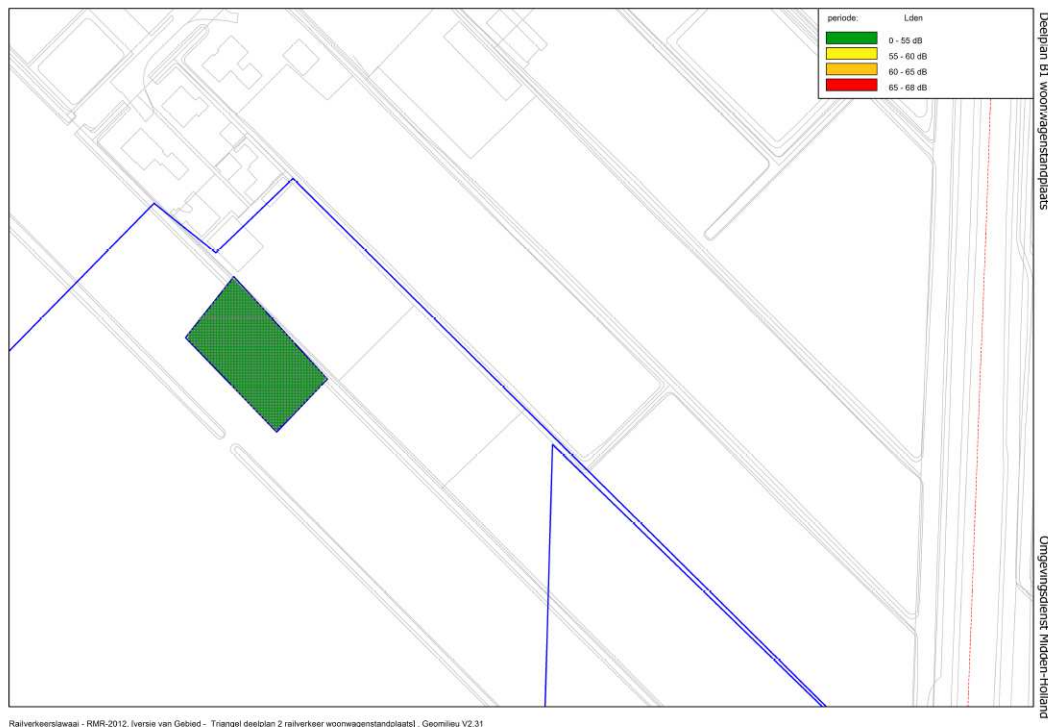
Figuur 3-2: Geluidscontouren t.g.v. de spoorlijn Gouda-Leiden ter plaatse van de geprojecteerde woonwagenstandplaats, hoogte 1,5 meter
