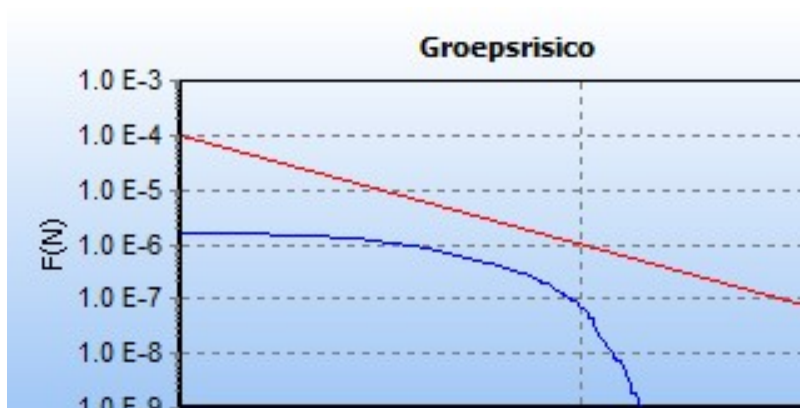
5.5 Figuur 5.5 FN curve voor 8028_leiding-W-517-01-deel-1 van N.V. Nederlandse Gasunie voor de kilometer tussen stationing 4110.00 en stationing 5110.00
