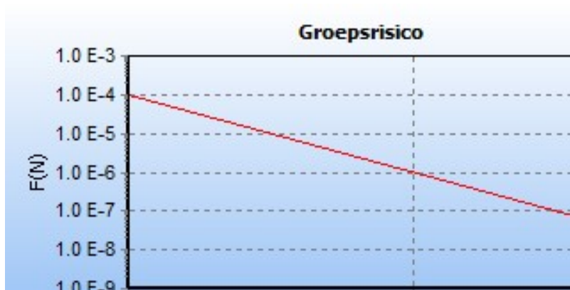
5.7 Figuur 5.7 FN curve voor 8028_leiding-W-521-01-deel-1 van N.V. Nederlandse Gasunie voor de kilometer tussen stationing 0.00 en stationing 200.00
