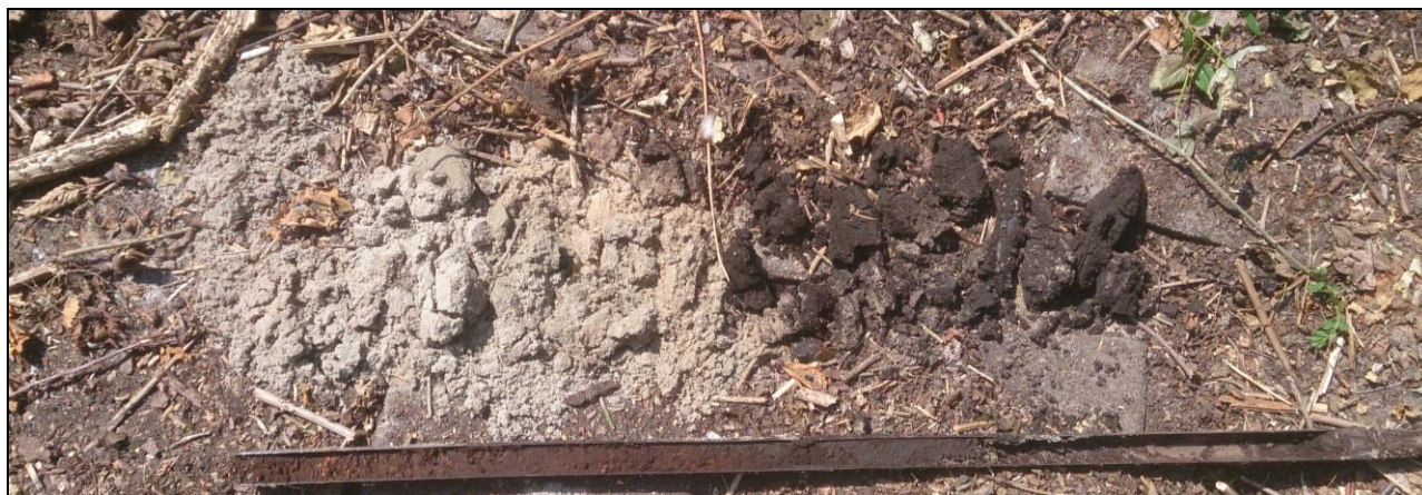
Figuur 5: boorprofiel van boring 6.
