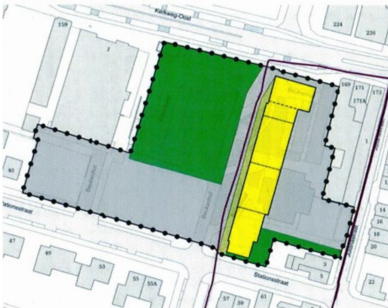
Afbeelding 1b: Schematische locatie van de 50kV-kabel (roze lijn) in het ontwerp
