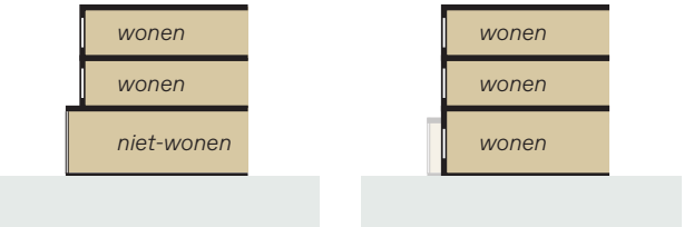
▲ Doorsnedes laten zien hoe de aansluiting van de rooilijn van de begane grond op de bestaande winkelstrip afhangt van de functie in de plint
