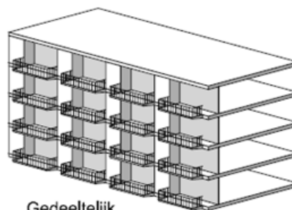
Gedeeltelijk inspringend balkon
