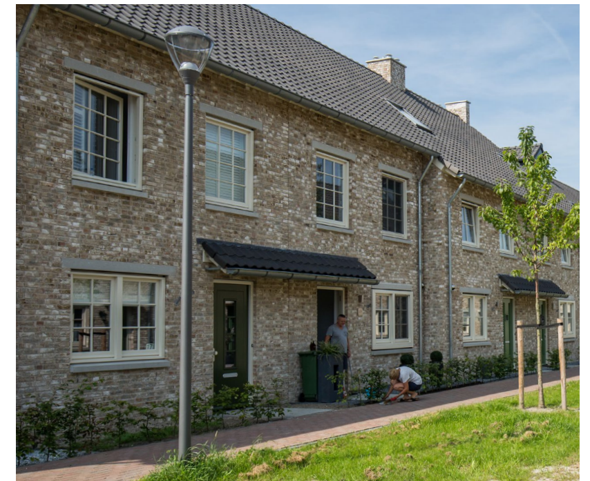
verlichtingsmast Schröder KIO LED op conische mast kleur; antraciet 4 m hoog
