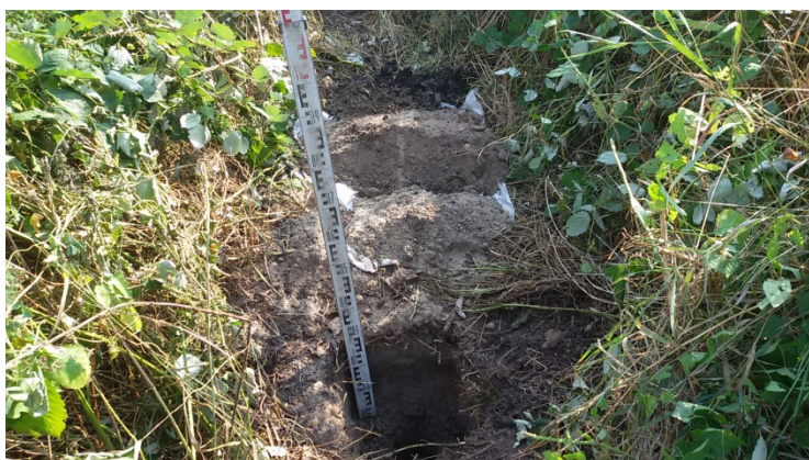
Foto 11, 12 en 13: Inspectiegat 02; op einddiepte; asbestverdacht materiaal uit laag 0,5-0,85 m-mv
