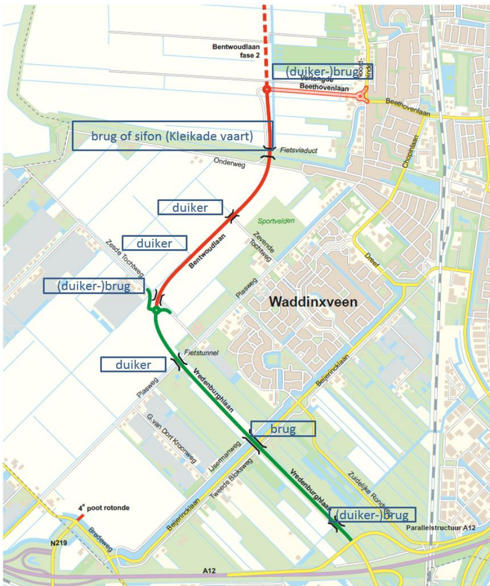
Figuur 15-8: Kruising van de weg met primaire watergangen en toepassing van duikers en bruggen.
