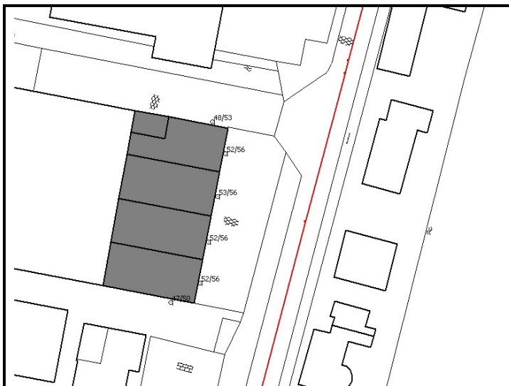
Figuur 14: Geluidsbelasting t.g.v. de N207 inclusief 2 dB aftrek artikel 110g Wgh.
