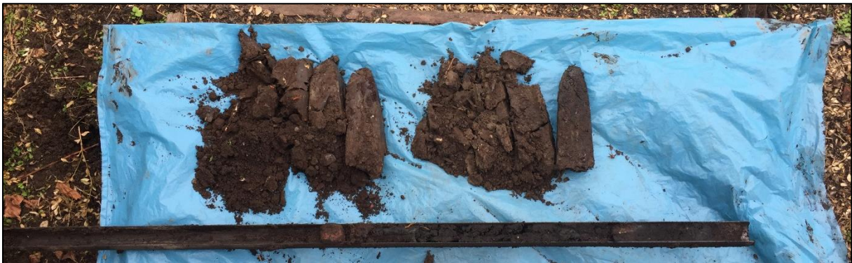
Boring 3: 0-160 cm -Mv. Meerdere puinlagen aangetroffen. Met name stuk grof puin op een diepte van 110 cm -Mv en geel puin waarin de boring gestaakt is.
