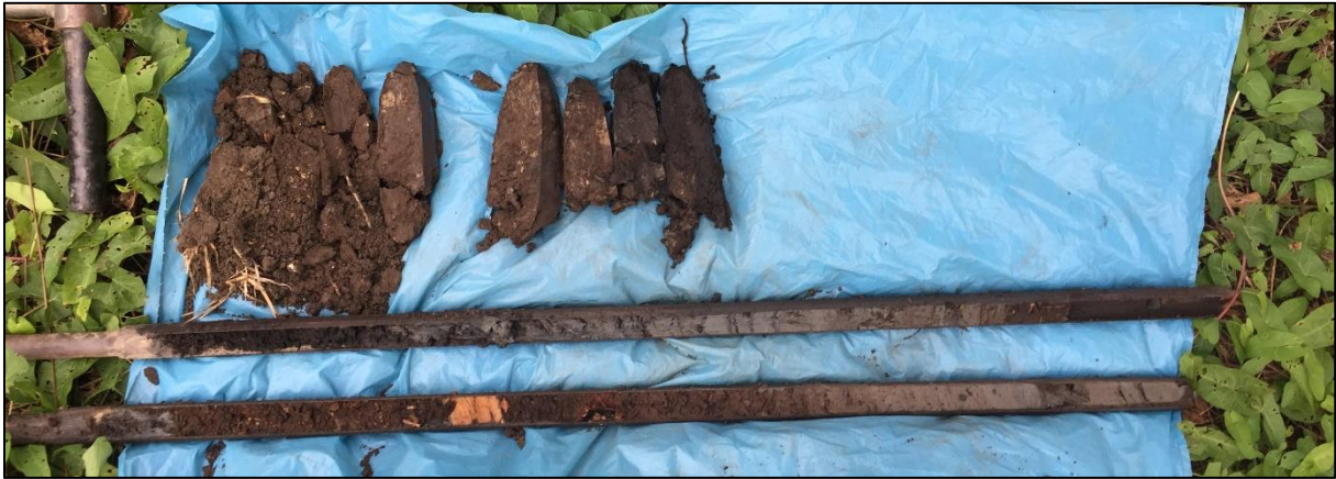
Boring 1: 0-300 cm -Mv. Dieper gelegen zand liep uit de boor onder invloed van de grondwaterstand.
