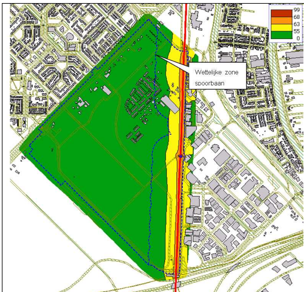
Figuur 2.15: L_{den} in contouren t.g.v. de spoorbaan Gouda-Alphen aan den Rijn op 10 meter hoogte
