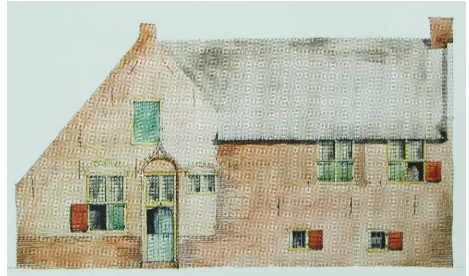
Deze reconstructie door W.J. Berghuis van de 17de-eeuwse voorgevel van de boerderij Veurseweg 215 laat goed zien hoe het onderkelderde deel aan het langhuis is gebouwd. Bron: Boerenerfgoed 2006.
