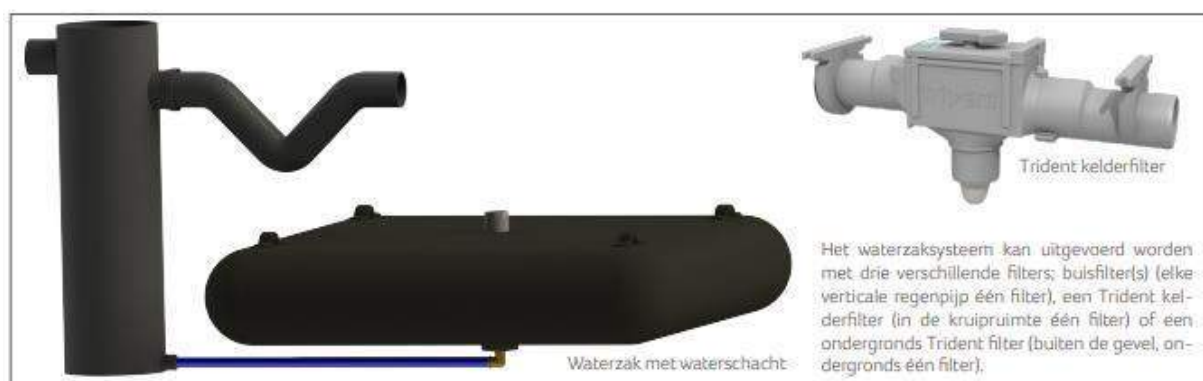
Afbeelding 10: Opslag van water onder de woningen (schematische weergave)
