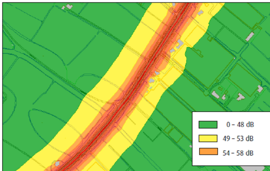
Figuur 4.1: Geluidscontouren ten gevolge van de N447, inclusief Rijnlandroute, waarneemhoogte 7,5 m, inclusief correctie conform artikel 110g
