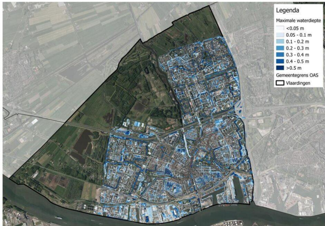
Figuur 4-17 Waterdiepte na hevige neerslag (70mm/uur) (Gemeente Vlaardingen, z.d.).
