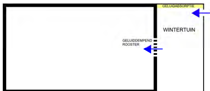
figuur 4.2. principe geluiddempend ventilatierooster in combinatie met een wintertuin
