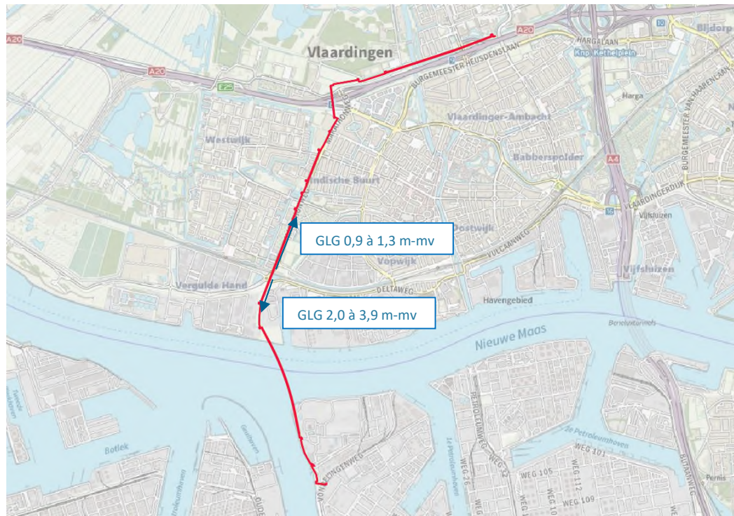
Figuur 2.2. Grondwaterstanden volgens het Landelijk Hydrologisch Model
