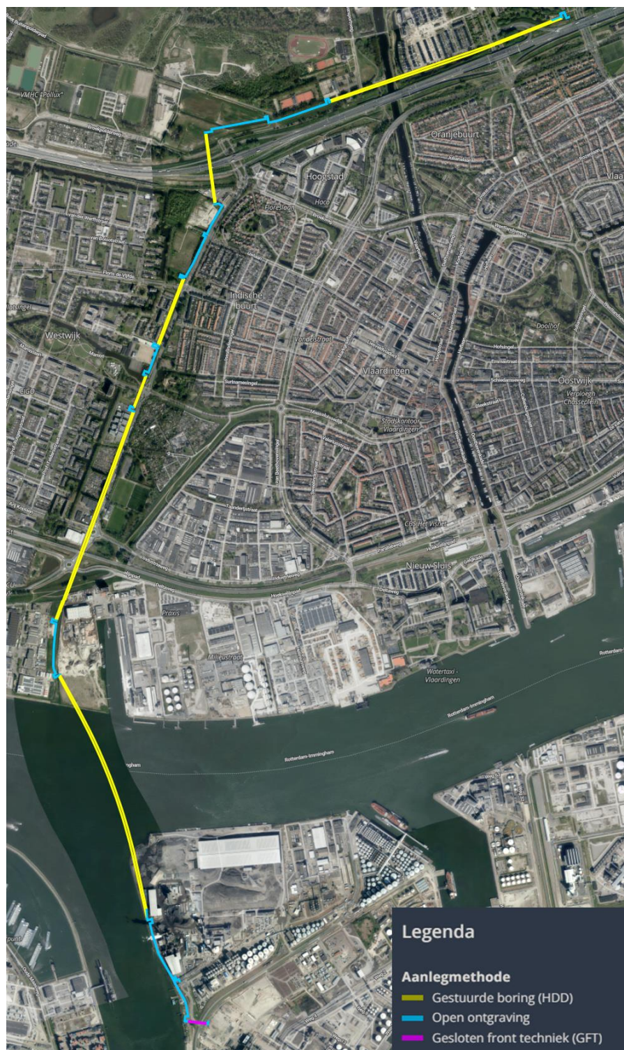
Figuur 2-1 Tracé Vondelingenplaat-Vlaardingen inclusief aanlegmethoden (bron: https://gas.projectatlas.app/warmtelinq/tracekaart-vondelingenplaat-vlaardingen/ )
