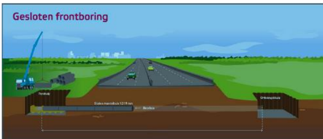
Figuur 2-4 Schematische weergave GFT boring
