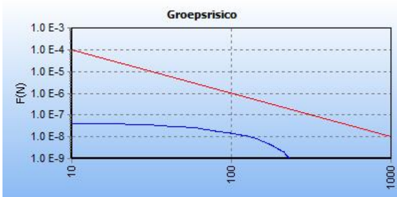
5.2 Figuur 5.2 FN curve voor 9100_leiding-A-517-deel-1 van N.V. Nederlandse Gasunie voor de kilometer tussen stationing 3530.00 en stationing 4530.00
