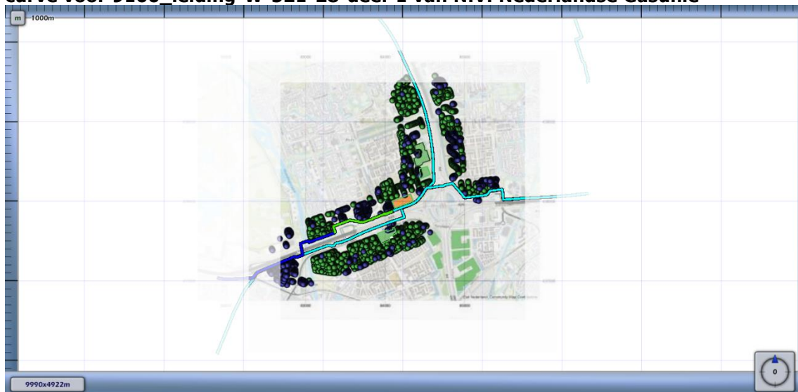
Figuur 4.7 Kilometer leiding behorende bij de maximale overschrijding van de FN-curve voor 9100_leiding-W-521-28-deel-1 van N.V. Nederlandse Gasunie
