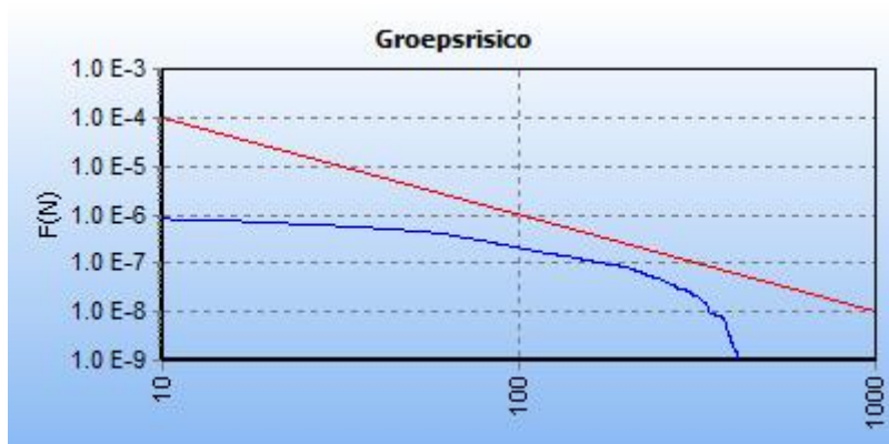
5.4 Figuur 5.6 FN curve voor 9100_leiding-W-521-28-deel-1 van N.V. Nederlandse Gasunie voor de kilometer tussen stationing 0.00 en stationing 1000.00
