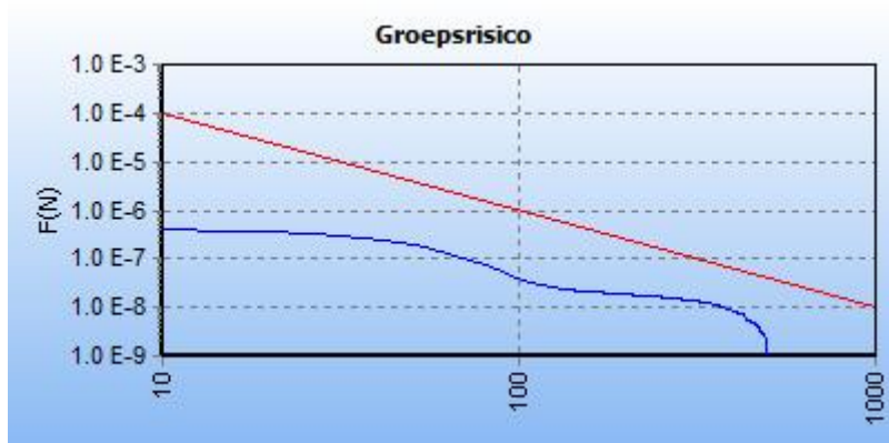
5.4 Figuur 5.6 FN curve voor 9100_leiding-W-521-28-deel-1 van N.V. Nederlandse Gasunie voor de kilometer tussen stationing 0.00 en stationing 1000.00
